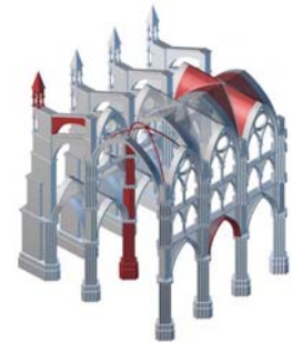
Tektonisches Schema einer gotischen Kathedrale
