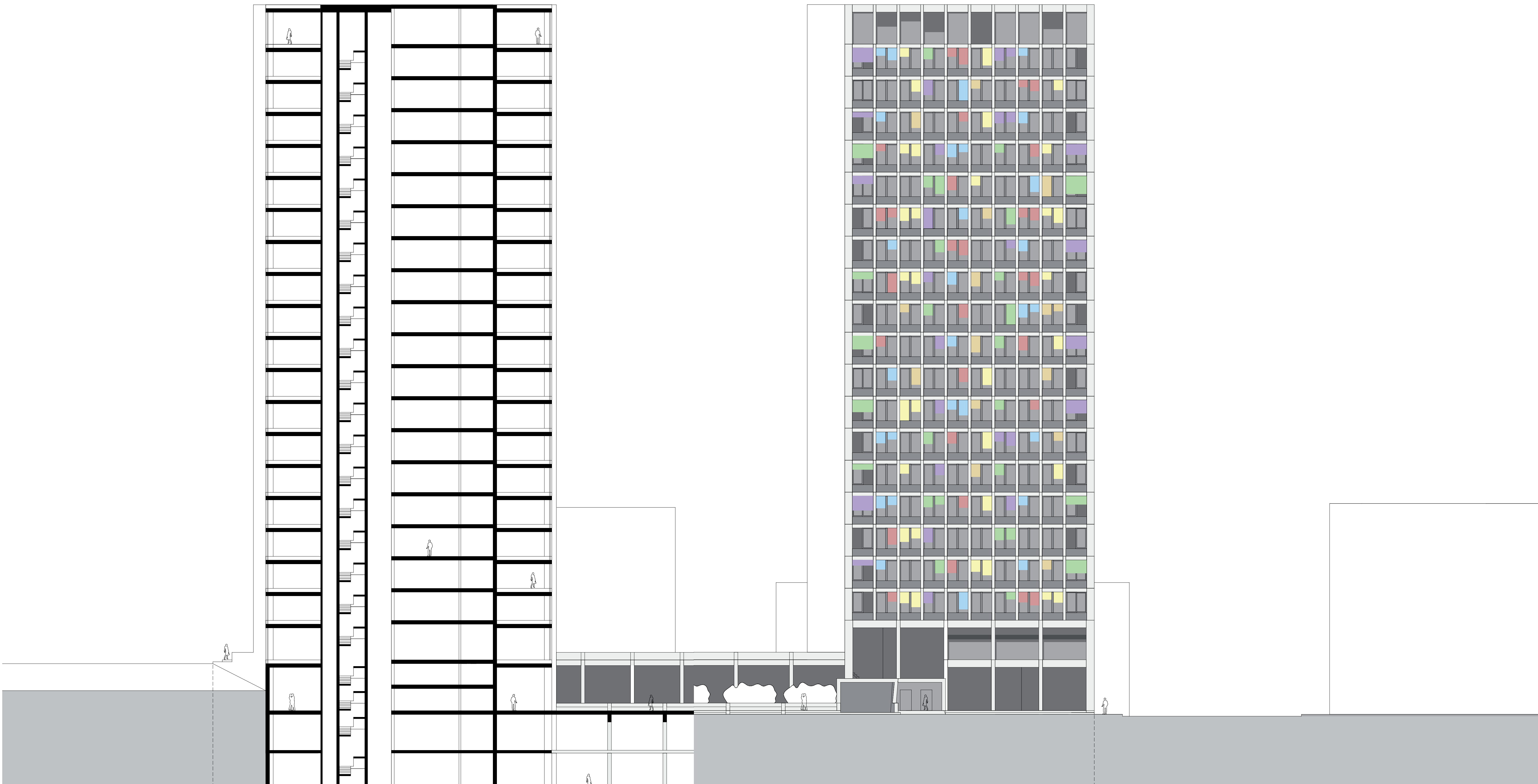
Schnittansicht Ostfassade (Schnitt durch Büroturm) 1:200
