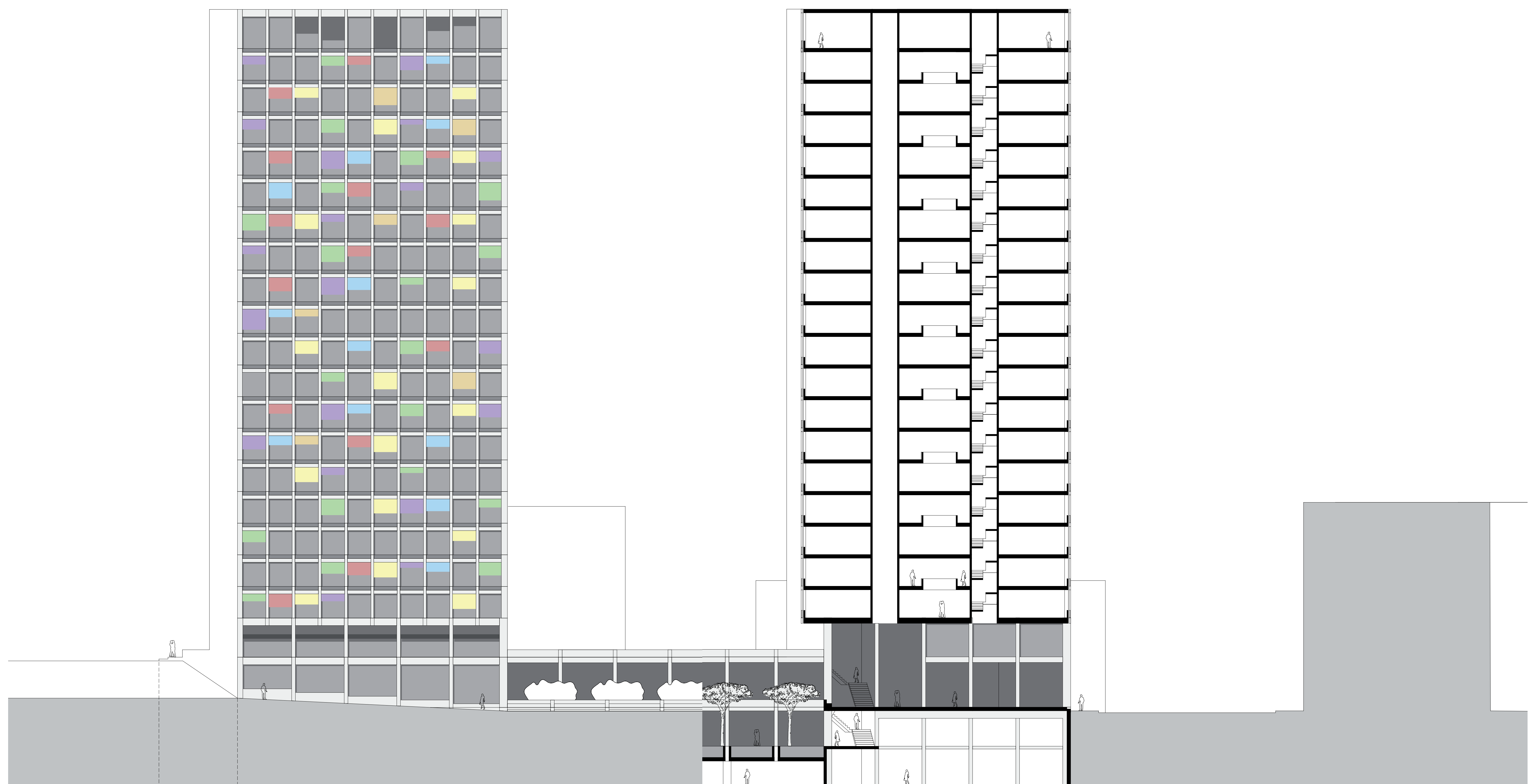
Schnittansicht Ostfassade (Schnitt durch Wohnturm) 1:200
